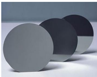
Plaquettes (wafers) en Si: diam. 10 cm, épais. 125 microns
