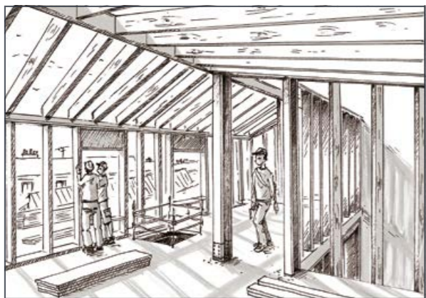
L'OSSATURE SECONDAIRE EN BOIS EST INSÉRÉE ENTRE LES TRAVÉES DE LA CHARPENTE MÉTALLIQUE PRIMAIRE. LE CHANVRE EST PROJETÉ ENTRE LES MONTANTS EN BOIS.
