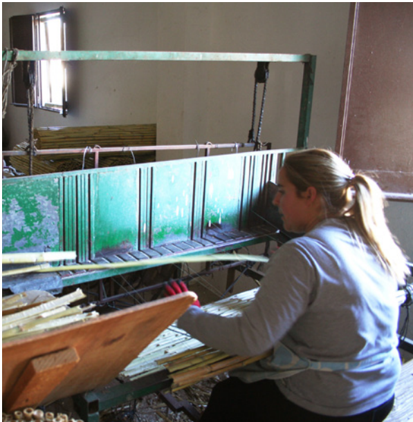
[Fotografía de Lucile Couvreur] (Valencia 2017) Telar para cañizos tradicional sin motorizar.
