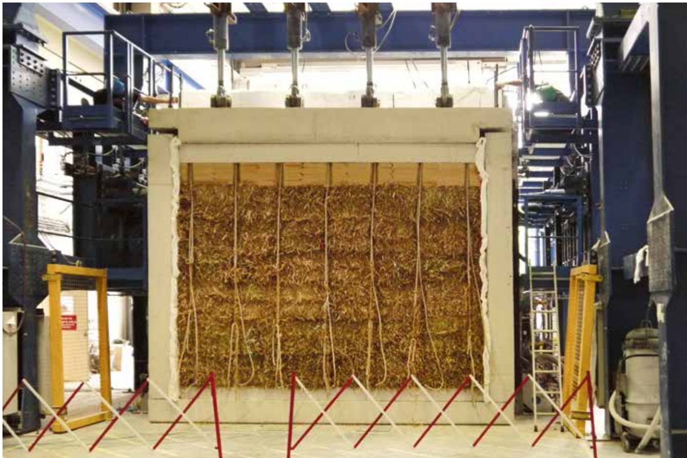
Centre de loisirs Jacques Chirac, mur en paille porteuse, tests R.E.I. (Résistance structurelle, étanchéité aux fumées et isolation à la chaleur) (VILLE DE ROSNY-SOUS-BOIS)
