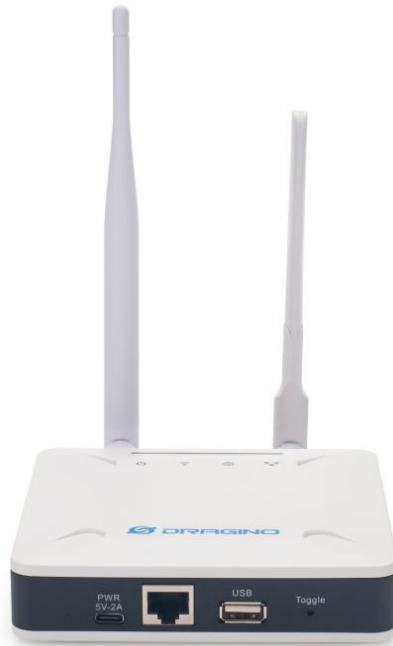
Figure 3 : gateway LoRaWAN « Dragino LPS8 »
