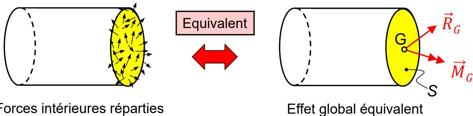
En statique appliquée, on se contente de trouver l'effet global produit par les forces intérieures au centre géométrique  $G$  de la section : une **force résultante**  $\vec{R}_G$  et un **moment résultant**  $\vec{M}_G$ .
