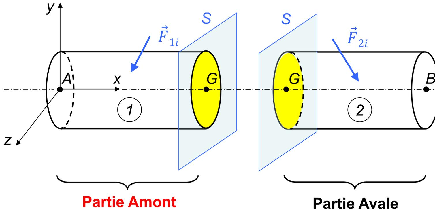
On peut alors isoler l'une des deux parties et écrire le bilan des actions mécaniques qui s'appliquent sur le tronçon.
