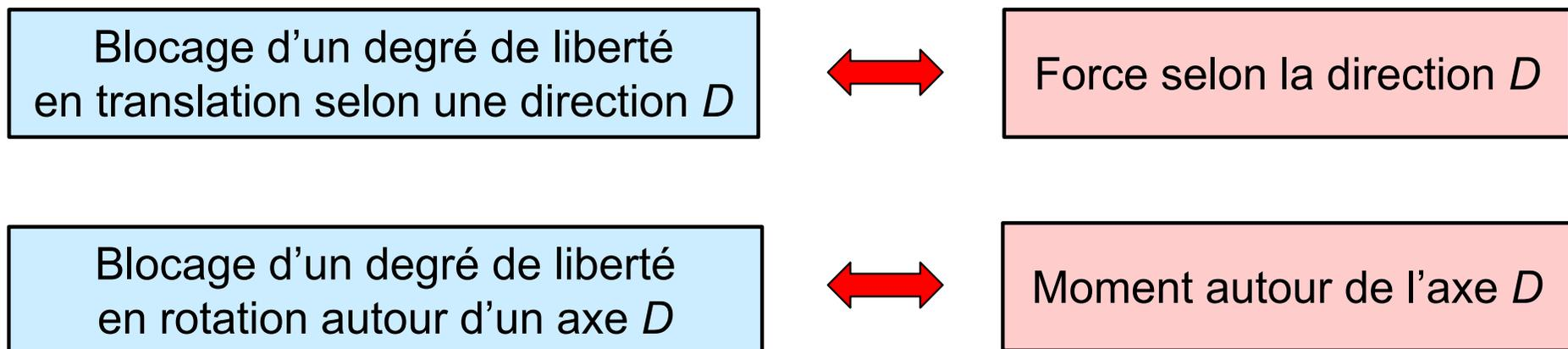
Appui simple (dans le plan)
