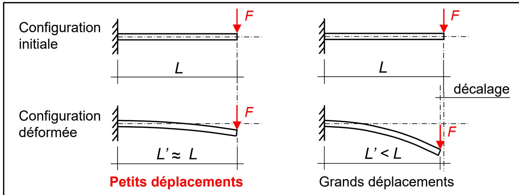
**Principe de superposition des effets statiques**
