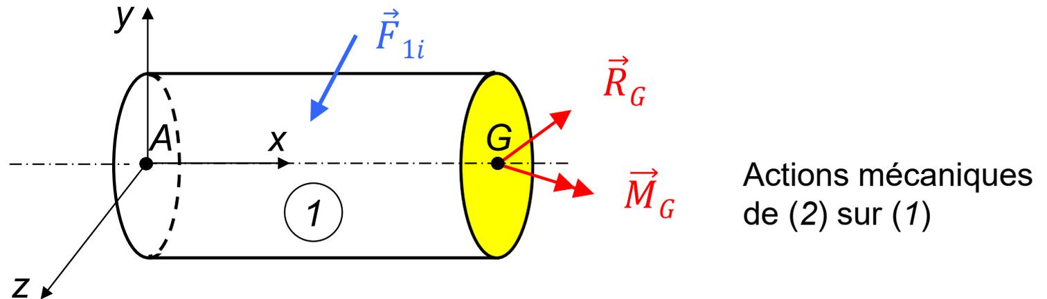
**Principe fondamental de la statique appliqué au tronçon (1)**
