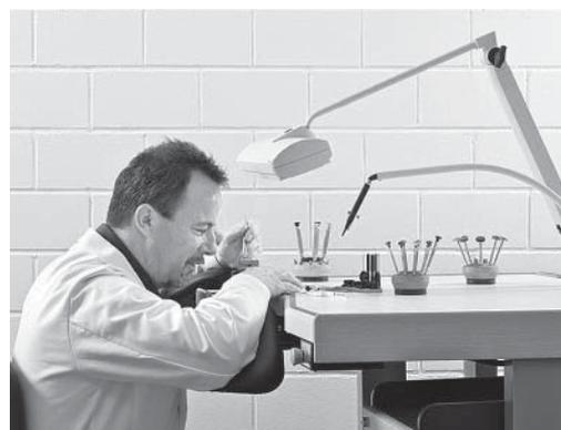
Fig. 1: l'éclairage d'un poste de travail doit pouvoir être adapté aux activités spécifiques (par ex. travail de précision).
