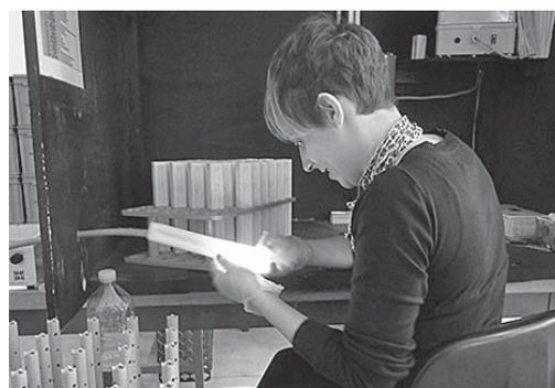
Fig. 6: des contrastes importants peuvent aussi être causés lors de travaux de contrôle par une lumière claire dans un environnement sombre.
