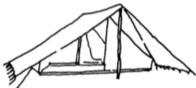
Les tentes de camping sont des structures simples et efficaces composées de tubes fins en aluminium qui s'emboîtent et soutiennent la toile tendue par une série de cordelettes maintenues par des piquets plantés dans le sol (sardines).
