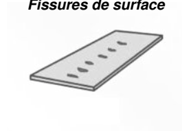
Fissures de surface
