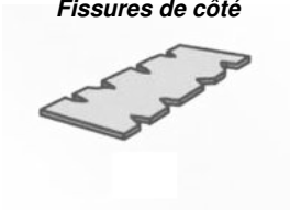
Fissures de côté
