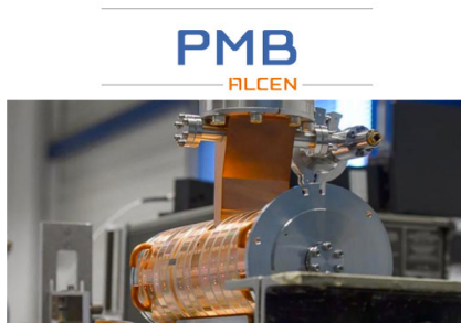
6MeV LINAC de la firme Oriatron 6e (eRT6; PMBALcen)
