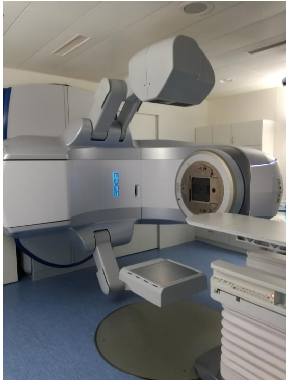
Système d'imagerie embarqué OBI (on Board imager) de Varian. Image AP avec tube RX à 0 degré. Latéral D avec tube RX à 270 degré.
