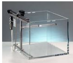
Cuve à eau utilisée pour mesurer le faisceau
