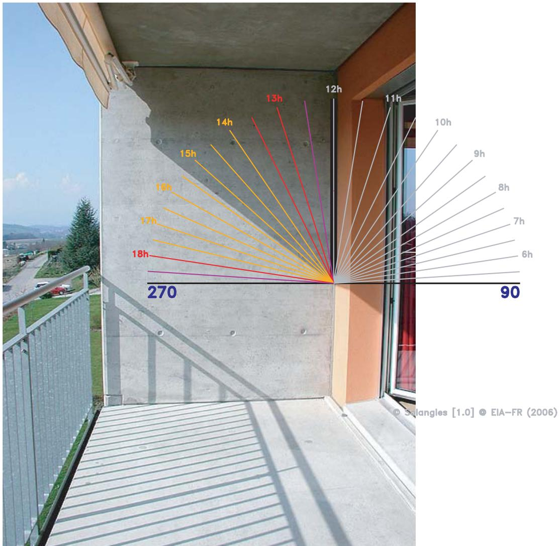
En superposant la photographie avec le diagramme de la vue en coupe, on constate que cette prise de vue a été réalisée aux alentours de 15h20 (heure vraie)
